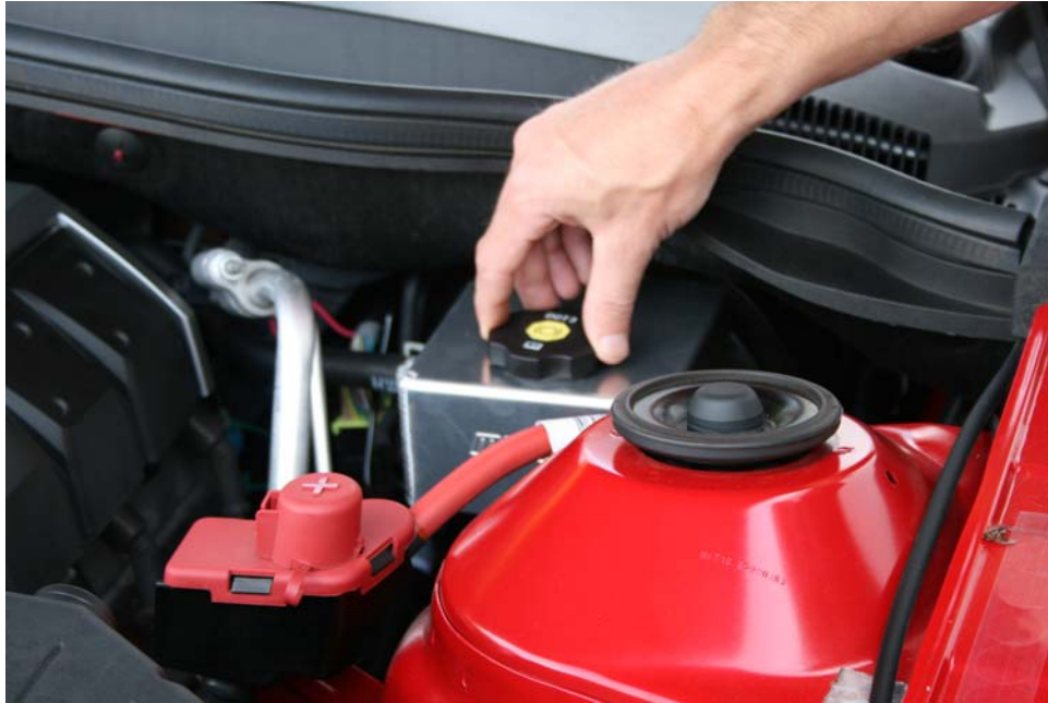
Step 6: Reinstall fill cap
